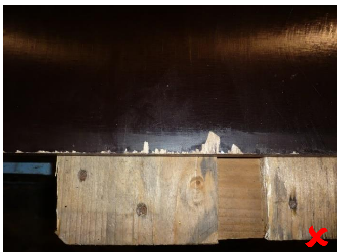
Fig. 6. Ejemplo de mecanizado inadecuado (sin apoyo)
